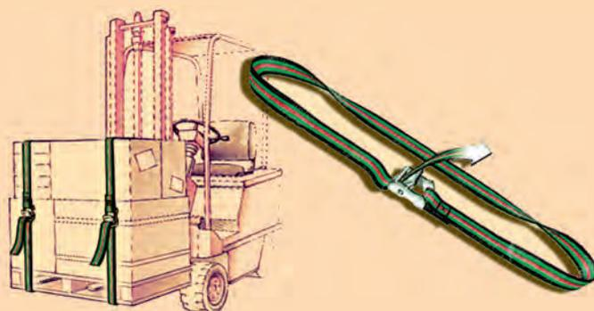
Sistema di ancoraggio con nastro di mm. 35 che si richiude ad anello su crichetto tenditore.
